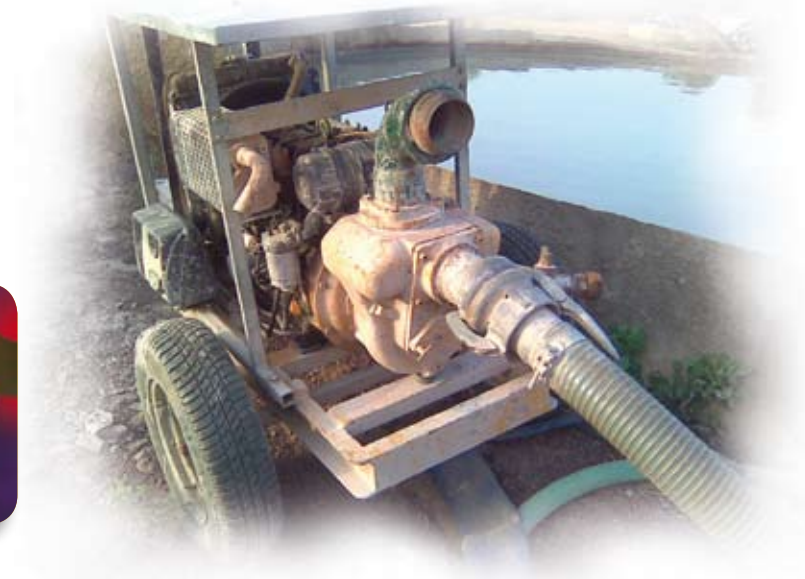
Robustesse du châssis, essieu démontable
