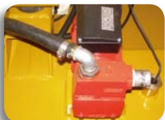
Pompe automatique de remplissage réservoir
