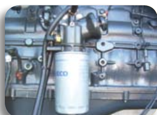
Préfiltre gasoil avec capteur de présence d'eau
